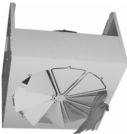
2 - A ventilátor lapátok beállítása
